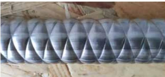
Nahaufnahme eines Kreuzdrallrohres mit gleichbleibend symmetrischer Oberflächenstruktur
