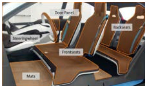
Hervorhebung der Oberflächen beheizt mit MaxiTherm – Anwendungsbeispiel im BMW i3
