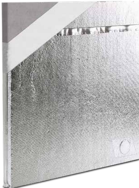
Das druckstabile Kernmaterial der VIPs besteht aus einem verpressten, mikroporösen Pulver. Der Pulverkern ist mit einer Hochbarrierefolie unter Anwendung einer speziellen Technik gasdicht verpackt und evakuiert, d. h. luftleer gepumpt. VIPs sind durch die verwendete Spezialfolie auch automatisch vor Eindringen von Luft und Wasserdampf geschützt.
